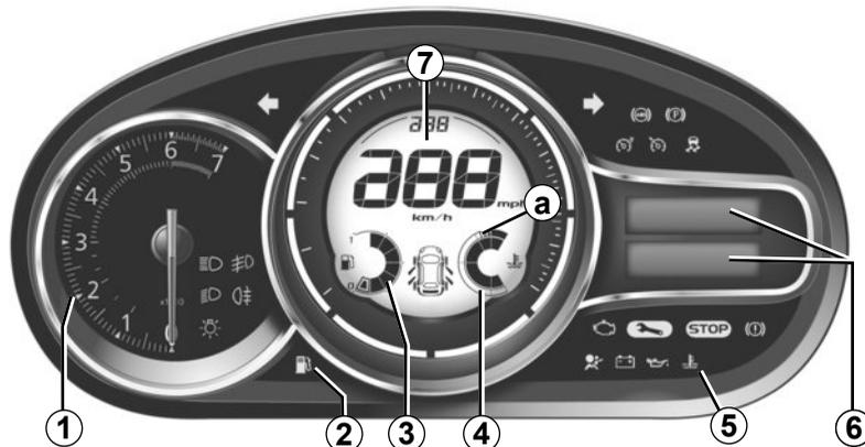
**Tacómetro del motor 1 (régimen del motor, régimen del motor X 1000)**
