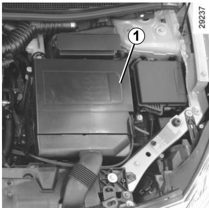
La batería **1** no necesita mantenimiento.
