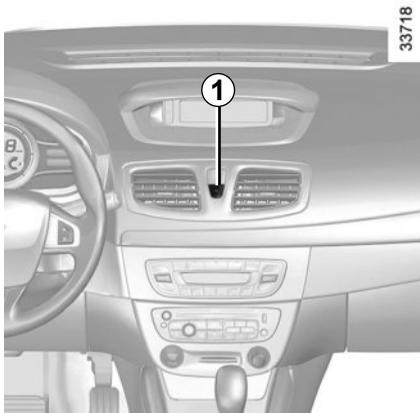
Tras arrancar el vehículo, el sistema condensa automáticamente los abrientes una vez alcanzada una velocidad de unos 10 km/h.
