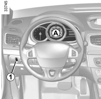
Al poner el contacto, el cuadro de instrumentos se enciende. Gire la rueda **1** para ajustar la intensidad luminosa del cuadro de instrumentos. En algunos casos, los testigos se encienden junto con el mensaje.
