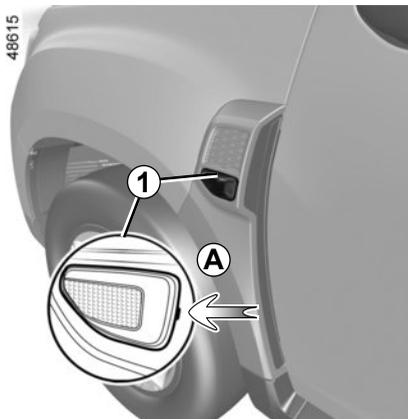
Suelte el repetidor **1** con un destornillador plano o similar colocado en **A** para bascular el repetidor hacia el exterior del vehículo.
