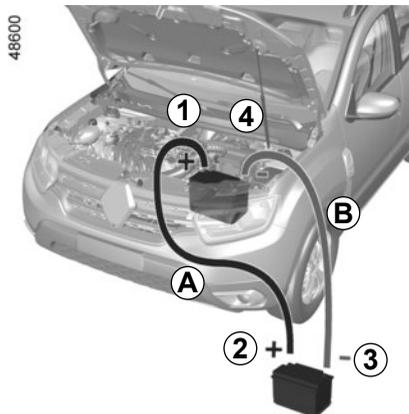
Fije el cable positivo (+) **A** al terminal (+) **1** de la batería descargada, y después al terminal (+) **2** de la batería que suministre la corriente.
