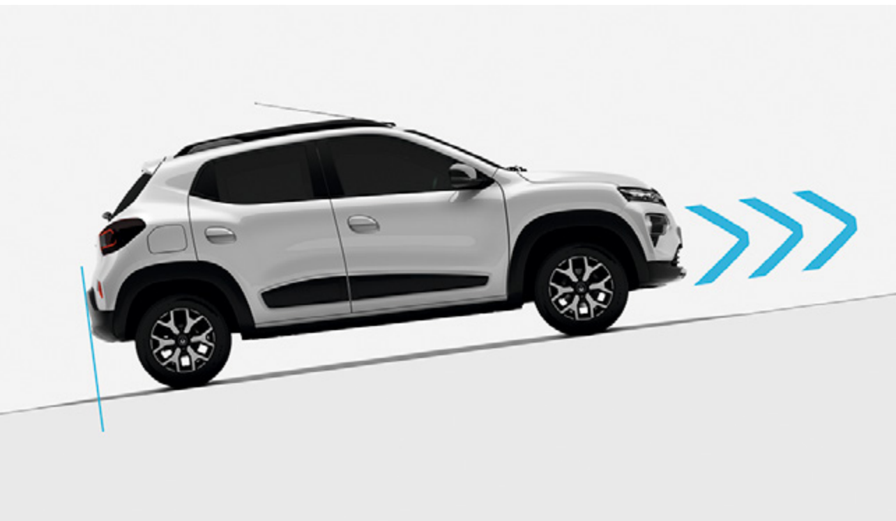
asistente de arranque en pendiente (HSA) HSA mantiene el vehículo detenido en pendientes, dándote tiempo para arrancar sin retroceder.
