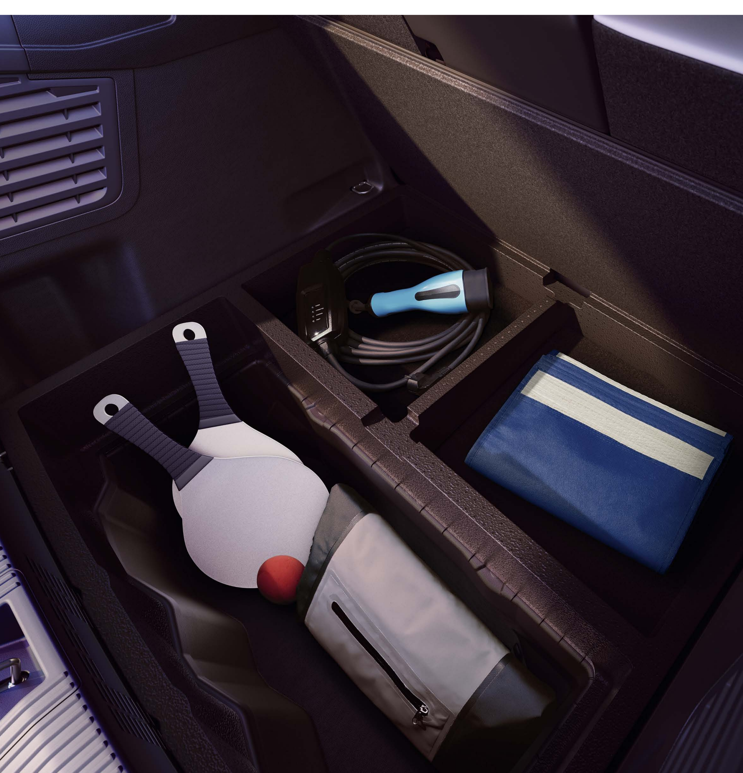
dubbele bodem met kabelopslag
