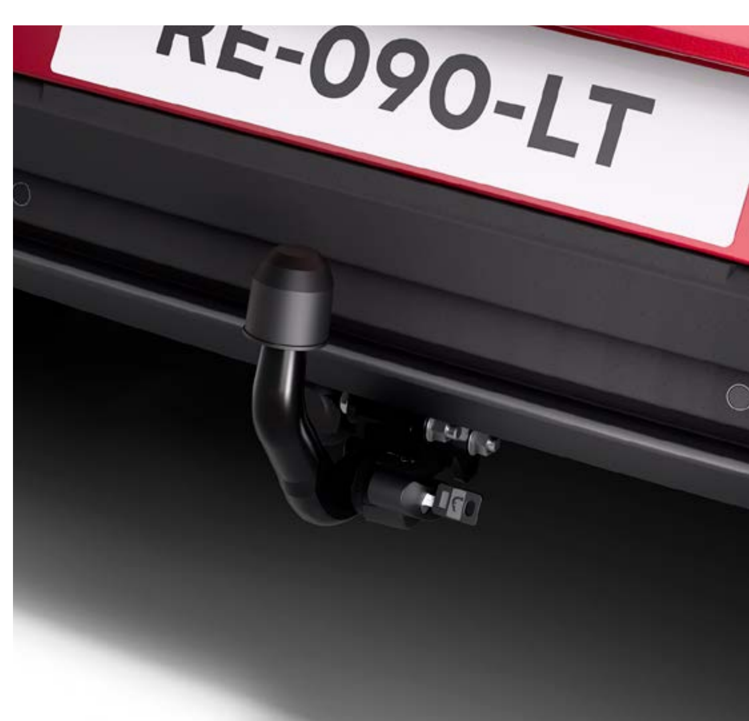
hak holowniczy demontowany bez użycia narzędzi
