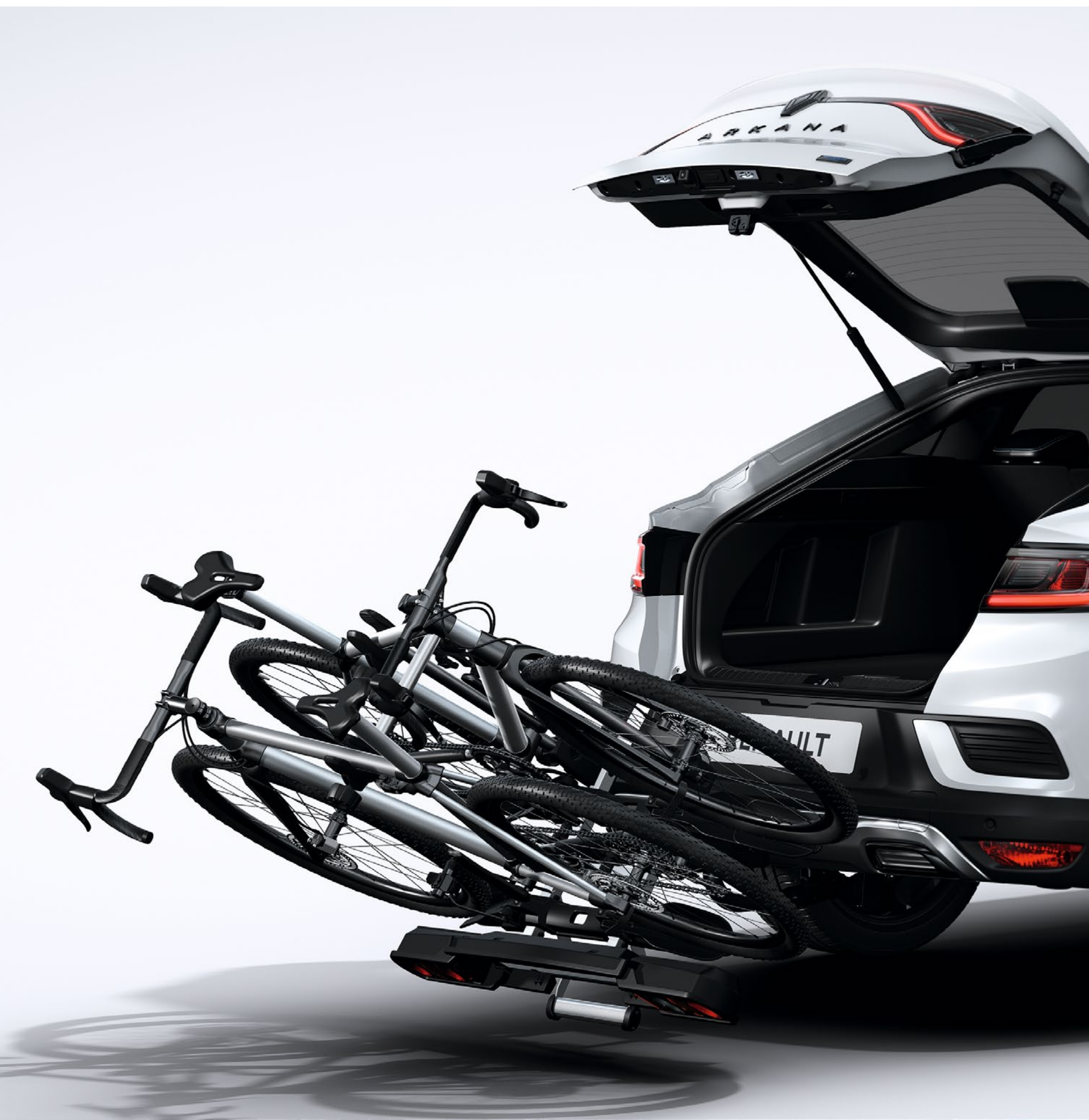
bagażnik na 2 rowery montowany na haku holowniczym z gniazdem 13-stykowym
