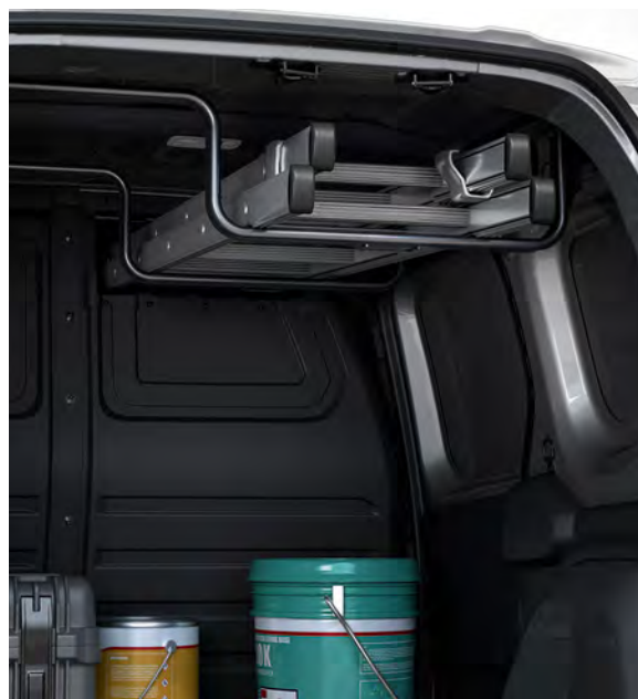
Easy Inside Rack – wewnętrzny stelaż podsufitowy
