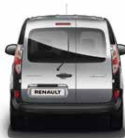
Dwuskrzydłowe, asymetryczne, przeszklone drzwi tylne z podgrzewaną szybą i wycieraczką
