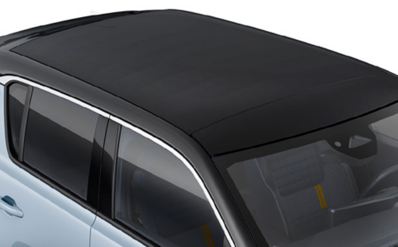
plócienny dach sterowany elektrycznie, dostępny w wersji techno „plein sud™”
