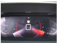
Ważne dane (np. prędkość) są wyświetlane bliżej oczu, na pochylonej płycie przed właściwym ekranem.
