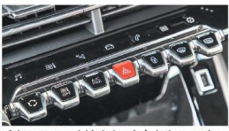
Efektowne przyciski obsługują światła awaryjne, zamki, ogrzewanie tylnej szyby itp. Dotykowe za nimi zmieniają funkcje ekranu centralnego.
