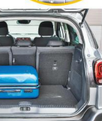
Kufer ma 410-520 l pojemności (zależy od położenia kanapy). Spory otwór i najniższy próg załadunku w teście – 67 cm nad ziemią.
