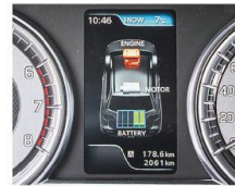
Przepływ energii w układzie młkiej hybrydy można obserwować na ekranie między zegarami.
