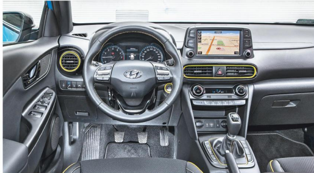
Kokpit Hyundai'a jest porządnie zmontowany (choć przy użyciu raczej przeciętnych tworzyw), ergonomiczny i łatwy w obsłudze. Liczne jaskrawe detale (mogą być także czerwone) wchodzą w skład pakietu Styl za 1700 zł – razem z częściowo skórzaną tapicerką. Na zdjęciu 8-calowa nawigacja, seryjny ekran centralny ma 7 cali, tak jak w Kii.
