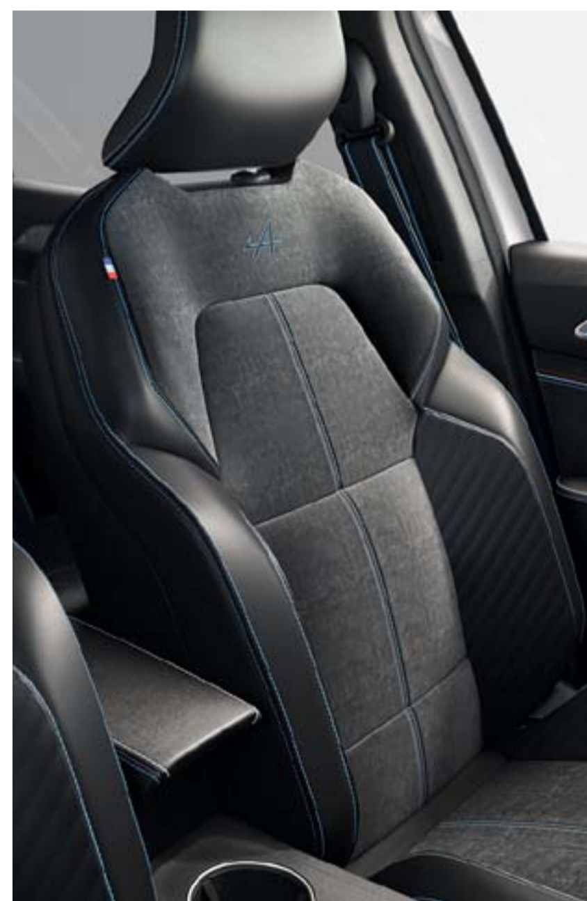
estofos específicos em tecido revestido com granulado de origem biológica / camurça preta
