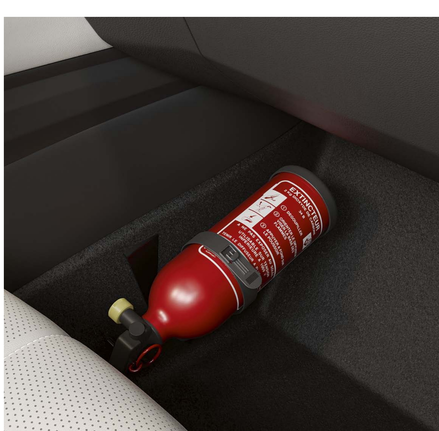
extintor de 1 kg com manómetro fixação para extintor
