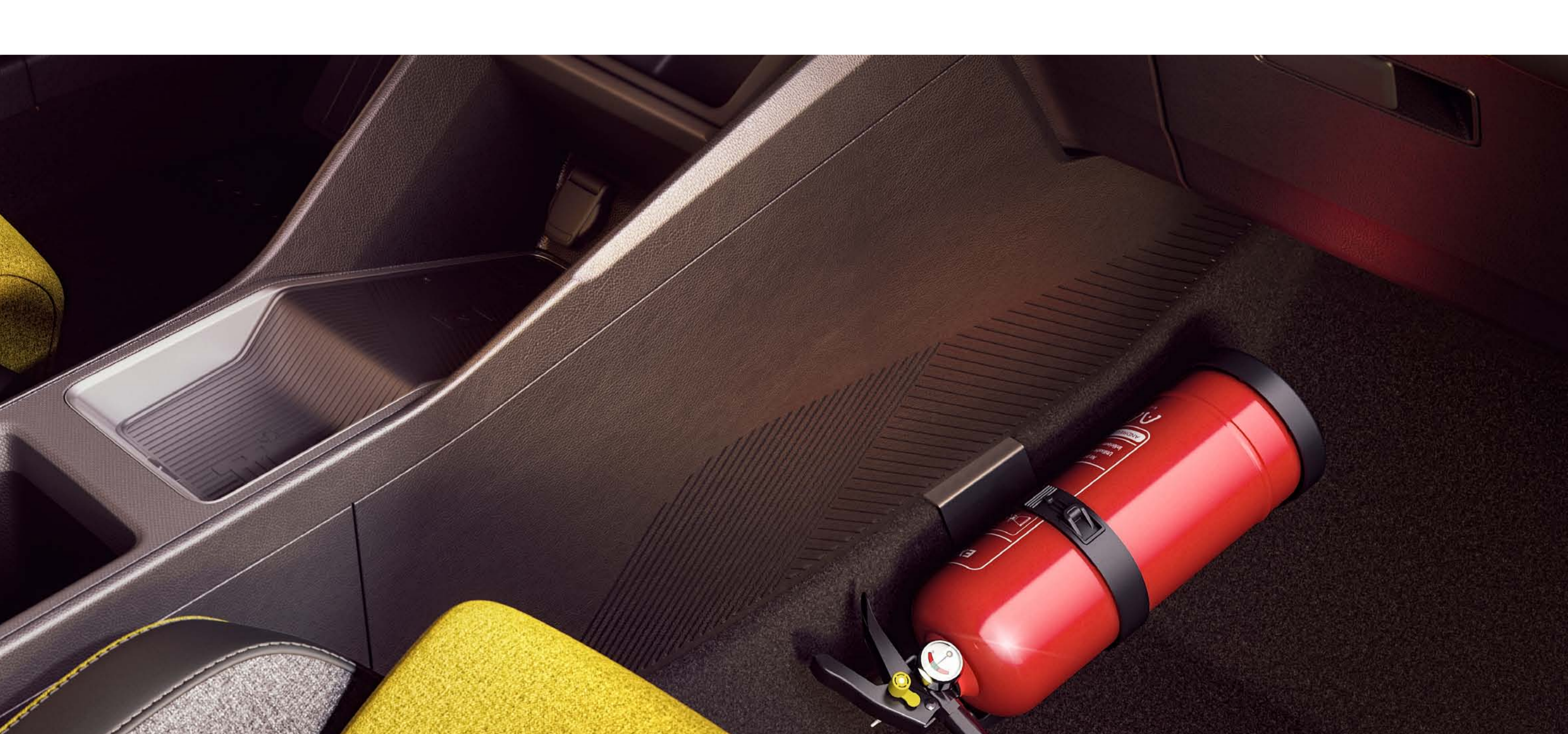
fixação para extintor
