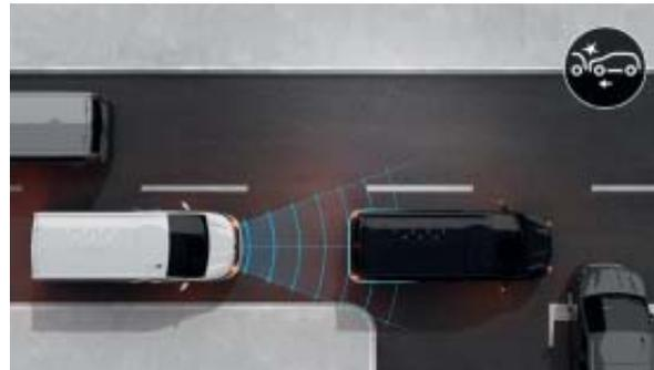
**O sistema de travagem de emergência ativa** permite-lhe evitar ou atenuar os efeitos dos pequenos «toques» na cidade ou em autoestrada, tanto de dia como de noite. O radar deteta o risco de colisão. Se não reagir ou se a sua reação não for suficiente, o sistema ativa-se e assume o controlo da travagem.
