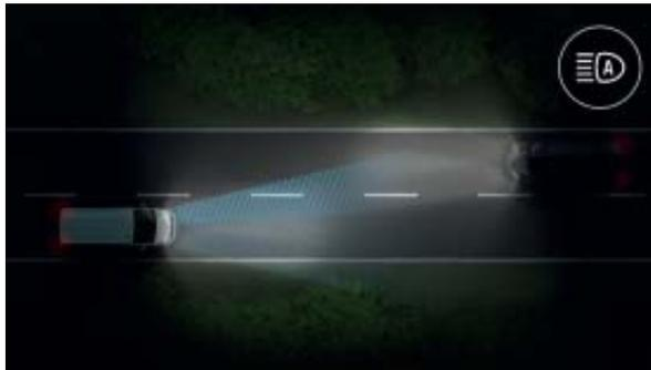
**A comutação automática das luzes de estrada/cruzamento** é obtida graças a uma câmara posicionada na parte superior do para-brisas. Esta câmara analisa o feixe luminoso em função das condições de iluminação e de circulação.
