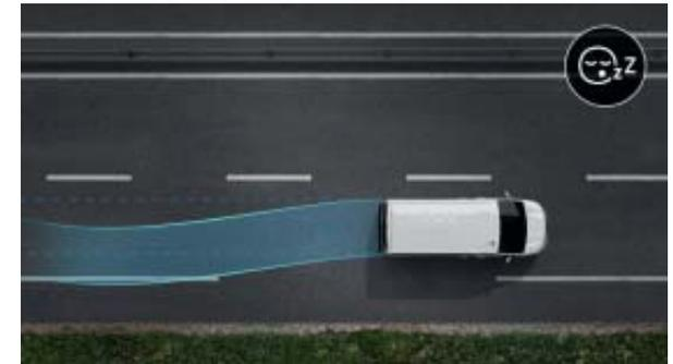
**O sistema de alerta de deteção de fadiga** analisa o comportamento do condutor pelos movimentos deste no volante, por exemplo. Uma mensagem visual e sonora no quadro de instrumentos convida-o a fazer uma pausa.
