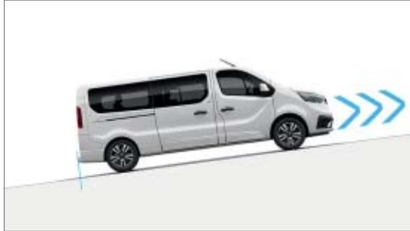
**O sistema de ajuda ao arranque em subida**, associado ao ESC, permite que a pressão de travagem se mantenha automaticamente durante 2 segundos para que disponha do tempo necessário para soltar o pedal de travão e pressionar o do acelerador. O sistema ativa-se quando a inclinação do piso é superior a 3%.
