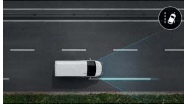
**O sistema de alerta de transposição involuntária de via**, ativo entre 70 km/h e 180 km/h, avisa-o através de um sinal visual e sonoro se ultrapassar uma linha contínua ou descontínua sem ativar o indicador de mudança de direção.
