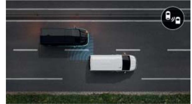
**O alerta de ângulo morto**, ativo entre 30 km/h e 140 km/h, previne-o automaticamente, através de um sinal luminoso, da presença de veículos não visíveis no retrovisor.
