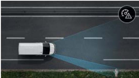
**O alerta de excesso de velocidade com reconhecimento dos sinais** de trânsito informa-o, através do quadro de instrumentos, dos limites de velocidade e alerta-o se ultrapassar a velocidade máxima permitida, graças a uma câmara posicionada na parte superior do para-brisas.
