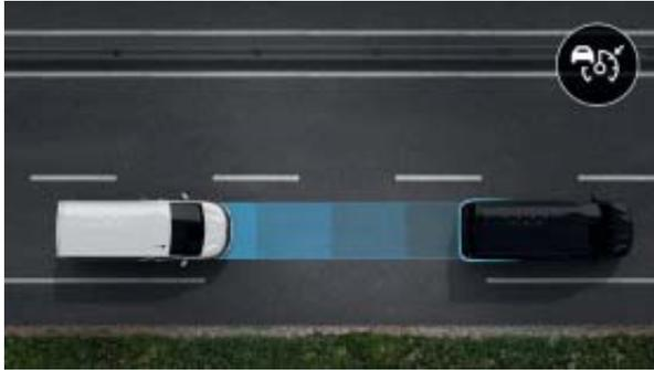
**O regulador de velocidade adaptativo** permite-lhe manter a distância de segurança adequada até ao veículo que circula à sua frente. O sistema atua nos travões quando a distância é demasiado curta e no acelerador quando a estrada está novamente desimpedida.
