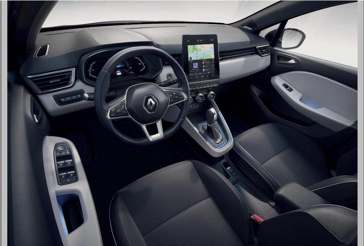
O botão de ativação da função Stop & Start, colocado por baixo do ecrã multimédia, é substituído por um botão “EV” específico, que permite forçar a circulação em modo elétrico – sob reserva do nível de carga da bateria.
