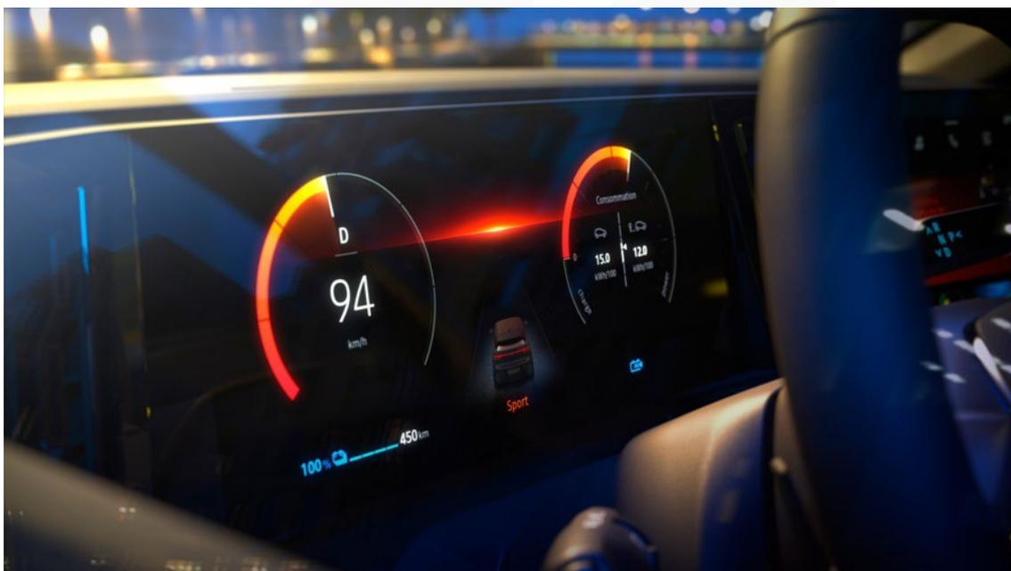
*Graças a um revestimento antirreflexo, que utiliza uma avançada tecnologia de micro-persianas, o tablier do novíssimo Mégane E-TECH Electric não tem "pala".*
