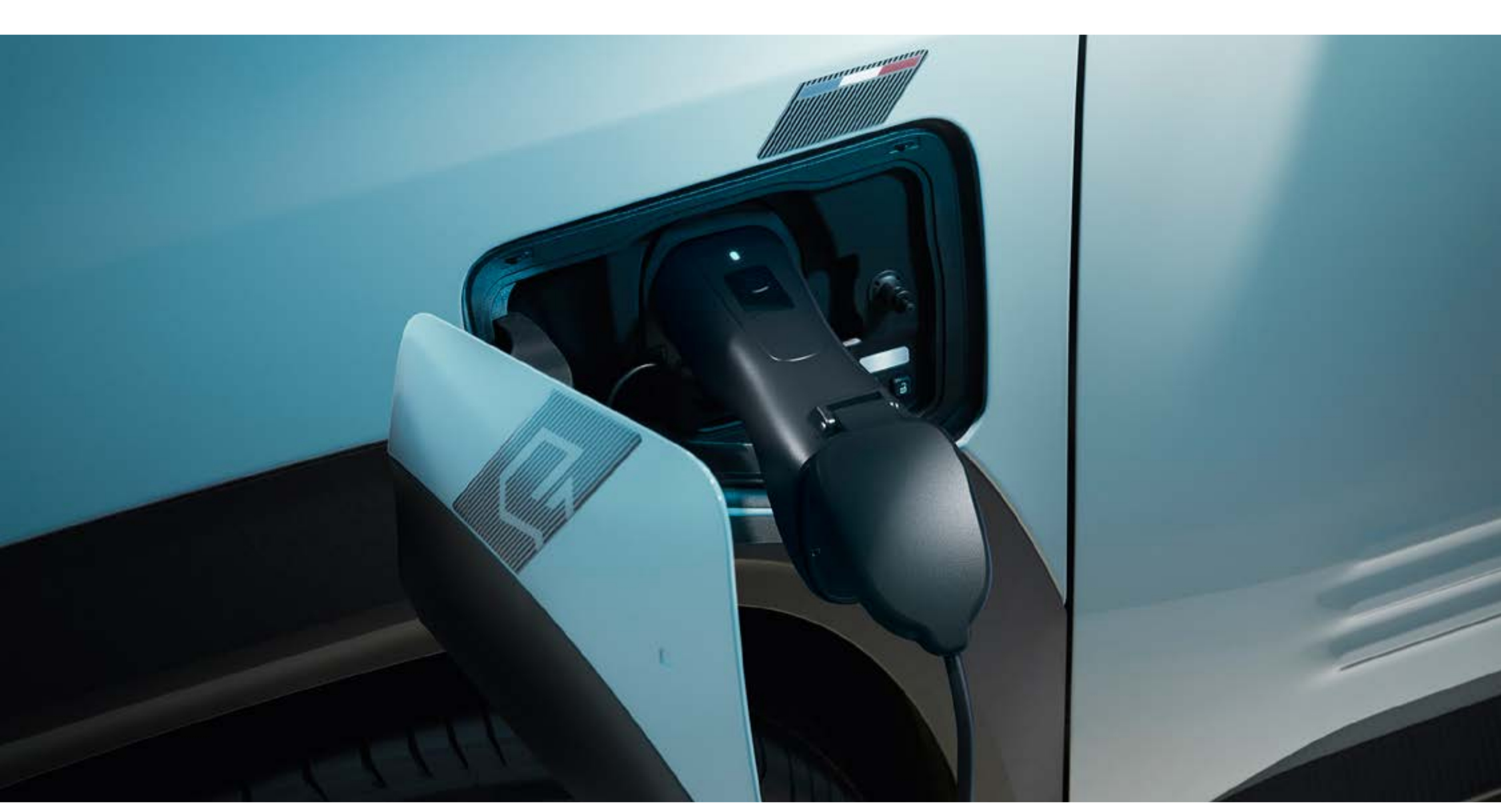
adaptor „power-to-object” (încărcare bidirecțională V2L (1) )
