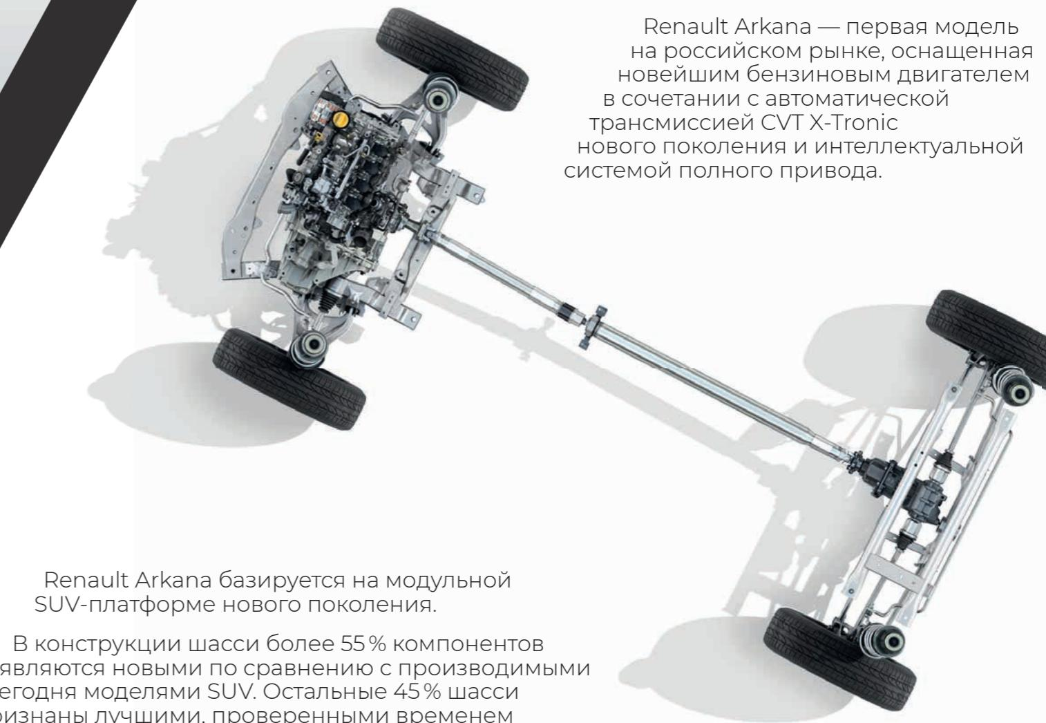
Новый двигатель TCe 150 с турбонаддувом (150 л. с.) разработан альянсом Renault-Nissan в сотрудничестве с концерном Daimler.
