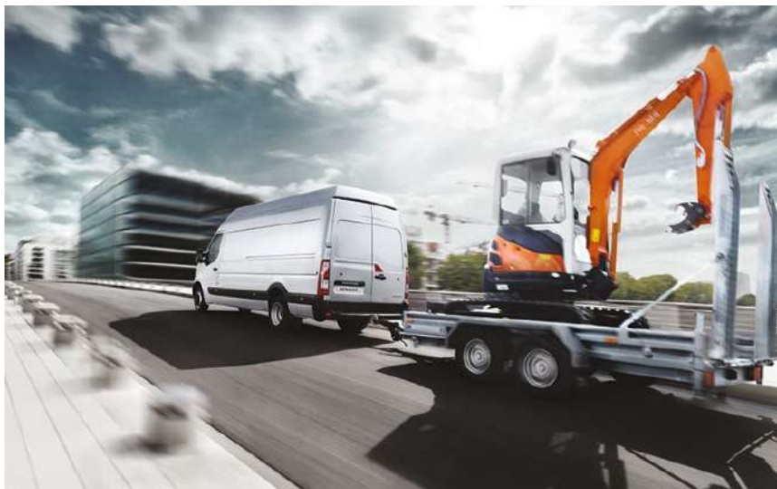
Система помощи при раскачивании прицепа при определении раскачивания (например, при сильном ветре) ограничивает крутящий момент двигателя и попеременно задействует тормоза на колесах.
