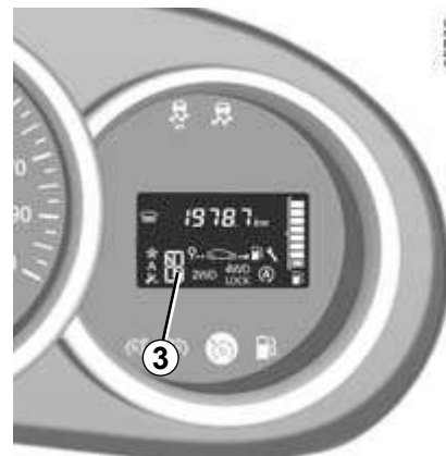
Дисплей автоматической коробки передач 3
