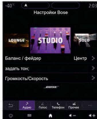
В режиме «Объемный звук» система обрабатывает разные звуки так, чтобы пассажиры, находящиеся в разных частях автомобиля, ощущали себя окруженными звуками со всех сторон.
