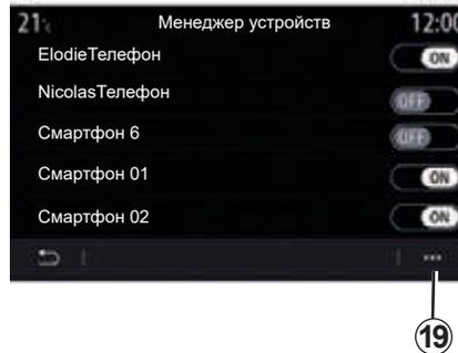
С помощью функции «Менеджер устройств» **17** можно выбрать смартфон, который будет автоматически подключаться для функции «репликация смартфона».
