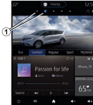
Виджеты позволяют сразу переходить на главный экран нужной функции, а в некоторых случаях — управлять этой функцией с одного из главных экранов (например, переключать радиостанции).
