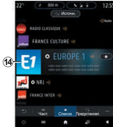
Если радиостанции не используют технологию RDS, или автомобиль находится в зоне с плохим приемом радиосигналов, название и логотипы радиостанций не появятся на экране. В верхней части списка будут показаны только их частоты.
