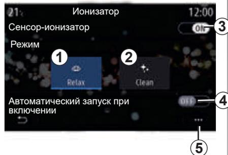
Активировать функцию автоматического включения и выключения ионизации можно путем выбора опции **4**.
