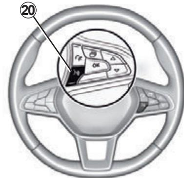
После запуска приложения «Android Auto™», «Яндекс.Авто™» или сервиса «CarPlay™» в мультимедийной системе можно использовать кнопку включения функции голосового управления **20** автомобиля для голосового управления некоторыми функциями смартфона. Дополнительные сведения см. в разделе «Использование системы голосового управления».
