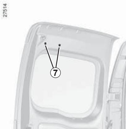
Чтобы заменить лампу стоп-сигнала, снимите две пластиковые заглушки **7** с внутренней стороны. Отсоедините стоп-сигнал, нажав отверткой на металлические защелки в гнезде.
