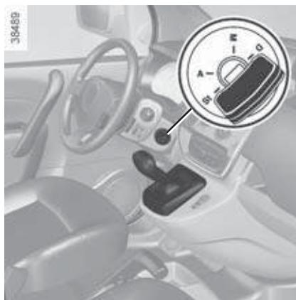
Перед буксировкой разблокируйте рулевую колонку, вставив ключ в замок зажигания. Поверните ключ в положение **M**.
