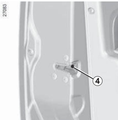
Дверь можно будет открыть только изнутри или с помощью ключа для передних дверей.
