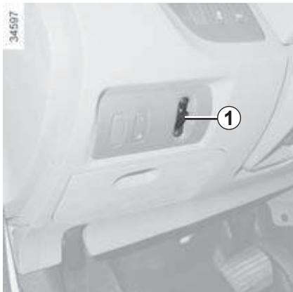
Регулировка высоты света фар осуществляется с помощью регулятора **1** в зависимости от загрузки электромобиля.
