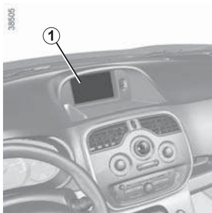
**Примечание:** в зависимости от комплектации электромобиля, кроме звукового сигнала на монитор **1** может выводиться видеоизображение заднего вида.
