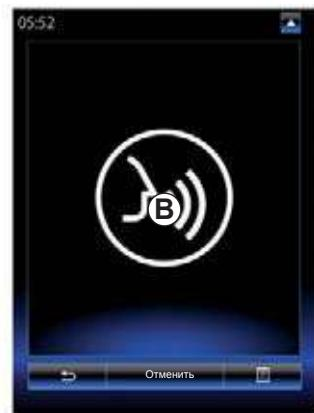
Для повторной активации совместной работы систем голосового управления телефона и мультимедийной системы кратко нажмите кнопку системы голосового управления в автомобиле или коснитесь экрана **B**.
