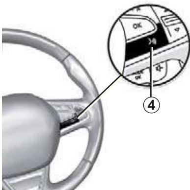
После активации приложения «Android Auto™» или «CarPlay™» в мультимедийной системе можно использовать кнопку включения функции голосового управления автомобиля для голосового управления функциями смартфона. Для этого нажмите и удерживайте кнопку **4** на рулевом колесе автомобиля (дополнительные сведения см. в разделе «Использование системы распознавания голосовых команд»).
