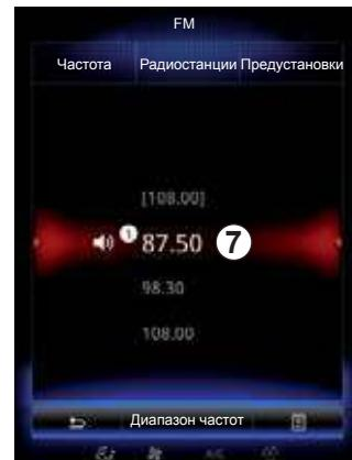
На экране не отображаются названия радиостанций, если они не используют систему RDS, а также если автомобиль находится вне зоны уверенного приема радиосигнала. Для них указывается только их частота, которая приводится в начале списка.
