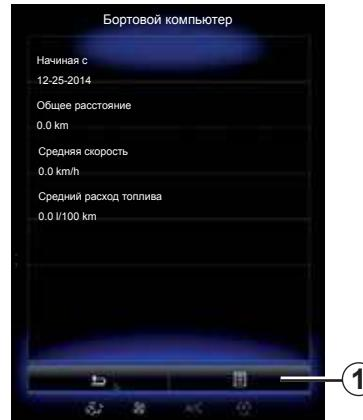
Для сброса и восстановления данных бортового компьютера и щитка приборов нажмите **1**, затем «Сброс».
