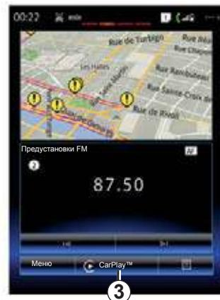
**Примечание.** Сервис «CarPlay™» работает только тогда, когда смартфон подключен к USB-разъему автомобиля.
