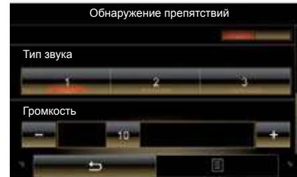
**Примечание.** Если функция «Звуковые уведомления» находится в положении «OFF», функции «Тип звука» и «Громкость» отключены.
