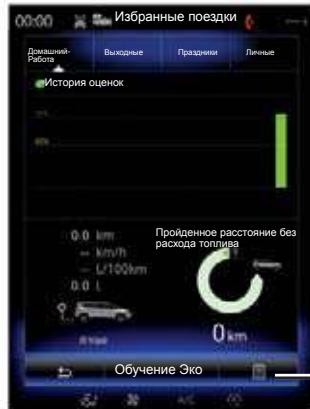
Чтобы удалить данные, нажмите соответствующий тип поездок, затем **4** и выберите «Удалить все поездки». На экране появится сообщение подтверждения. Нажмите «Да», чтобы удалить все поездки или «Нет», чтобы отменить удаление.
