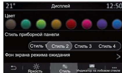
На вкладке «Стиль» **2** выберите один из стилей дисплея щитка приборов.
