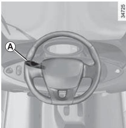
Фары ближнего света включаются автоматически при запуске двигателя без всякого воздействия на подрулевой рычаг **A**.
