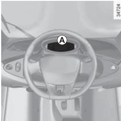
Приборный щиток **A**: загорается при включении зажигания.
