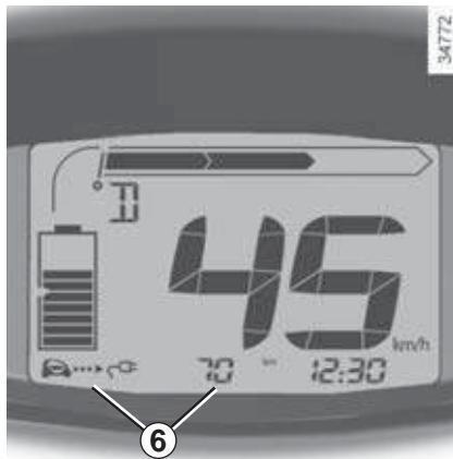
При последовательном нажатии кнопки 5 в зонах 6 дисплея отображаются следующие индикации:
