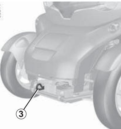
Для буксировки разрешается использовать только передние и задние отверстия буксировочных проушин 3.
