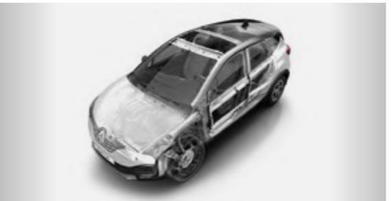
**Усиленный кузов и подушки безопасности.** Форма, толщина и жесткость элементов кузова оптимизированы для того, чтобы эффективно поглощать и рассеивать удар. В совокупности с подушками безопасности (2/4) это помогает защитить водителя и пассажиров в случае аварии.
