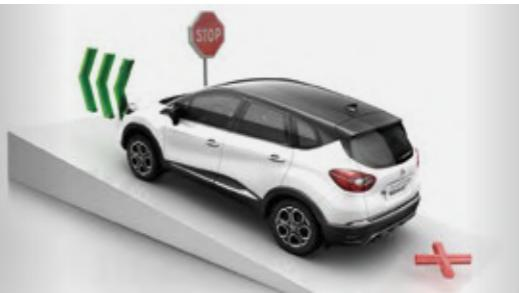
**Система помощи при трогании на подъеме (Hill Start Assist).** Предотвращает откат автомобиля назад при трогании на подъеме.
