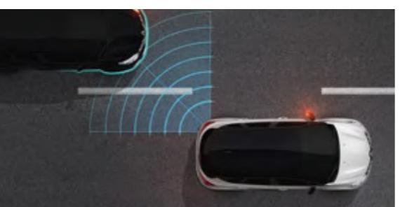
**Система контроля слепых зон.** LED-сигналы в боковых зеркалах предупреждают вас о нахождении другого автомобиля в слепой зоне, чтобы избежать столкновения при совершении маневра.
