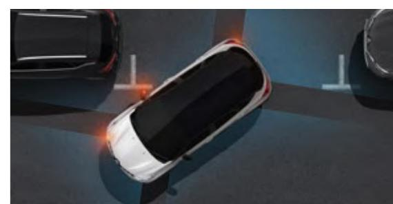
**Система камер кругового обзора** передает изображение с одной из четырех камер (заднего и переднего вида, а также боковых, встроенных в корпусы наружных зеркал) на экран мультимедийной системы EASY LINK.
