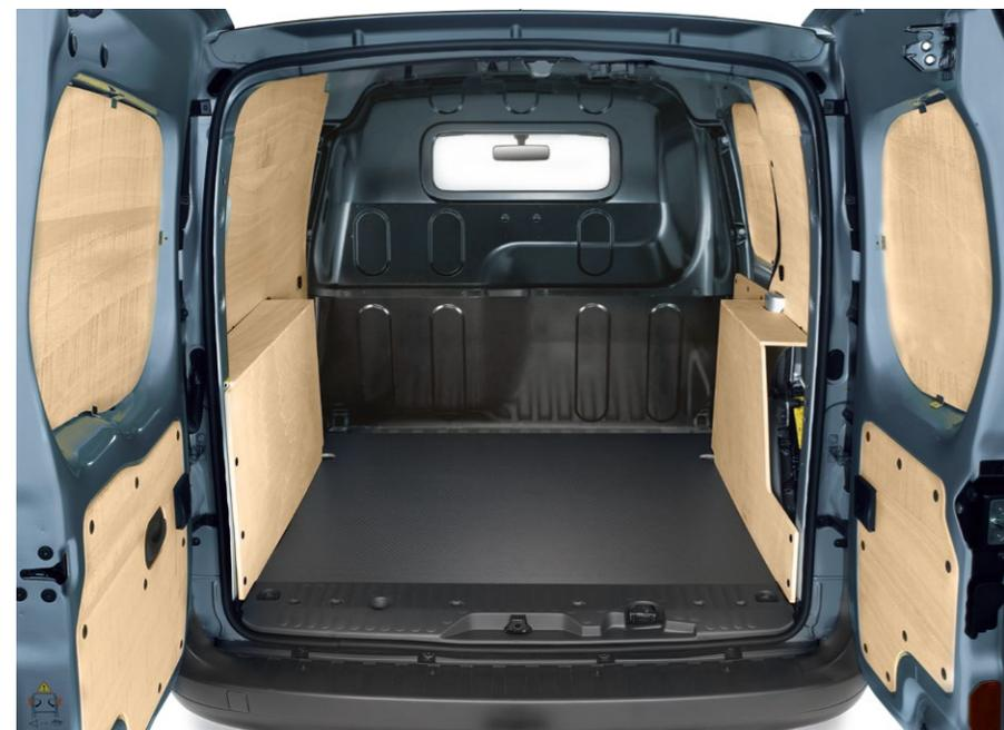
Несколько видов перегородок грузового отсека позволяют легко перевозить грузы различных размеров. Поворотная решетчатая перегородка и складывающееся сиденье пассажира увеличат полезный объем и длину грузового отсека. А металлическая перегородка в 1/3 высоты обеспечивает транспортировку длинных и громоздких предметов.
