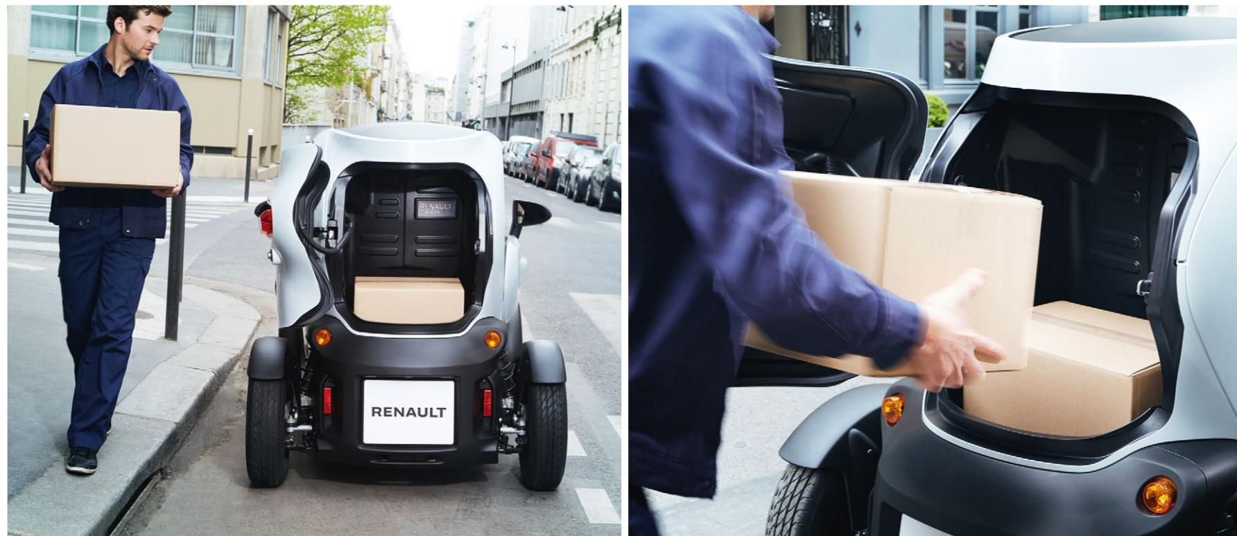
Задняя дверь открывается на 90°, багажное отделение с легкостью вмещает малогабаритные грузы. Объем багажника составляет 200 л, а грузоподъемность TWIZY CARGO – 75 кг.
