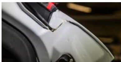
Sprickbildningar i karosskarvarna på Teslas bakklucka imponerar ej. Rostriskt!
