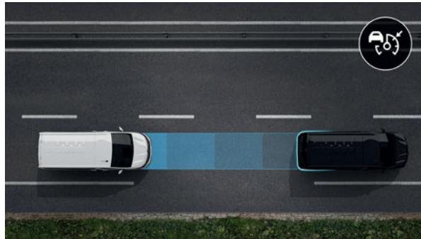
**Adaptiv farthållare** hjälper dig att hålla ett lagom avstånd till framförvarande fordon. Systemet bromsar bilen om avståndet blir för litet och gasar när kusten är klar.
