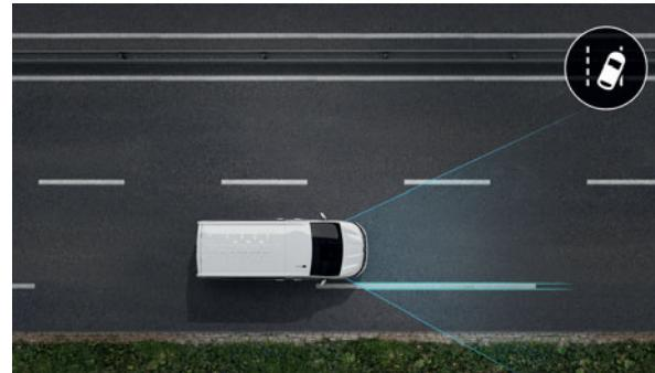
**Varningsfunktionen om bilen lämnar körfältet** är aktiverad i hastigheter mellan 70 km/h och 180 km/h. Systemet varnar dig om du kör över en heldragen eller streckad linje utan att blinka.
