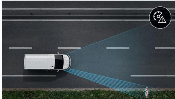
**Fortkörningsvarnare med trafikskytsavsläsning** påminner dig om hastighetsgränsen med en indikering på instrumentpanelen och varnar om du kör för fort tack vare en kamera längst upp på vindrutan.
