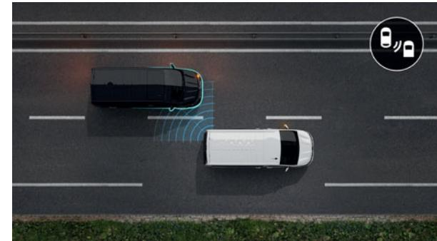
**Dödavinkelvarnaren** som är inkopplad i hastigheter mellan 30 km/h och 140 km/h varnar dig automatiskt (med en ljussignal) om det ligger en bil bredvid eller strax bakom som du inte ser i ytterbackspegeln.
