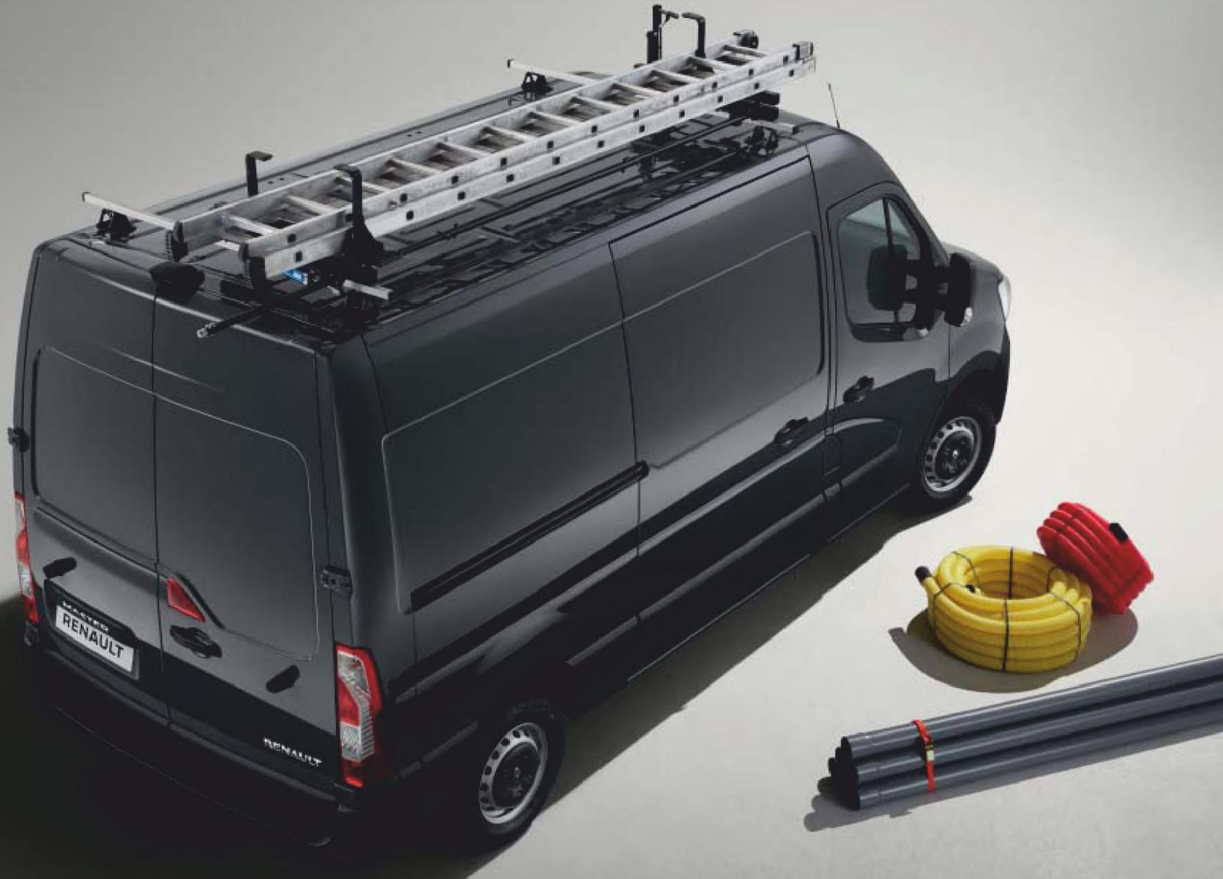
**1. Lasthållare.** Mycket praktiskt för att transportera skrymmande last: cykelhållare, takbox och arbetsmaterial till exempel. Uppfyller säkerhets- och hållfasthetskraven med råge. Finns som sats med två bågar (max. lastvikt: 89,5 kg) eller fyra bågar (max. lastvikt: 181,5 kg).
