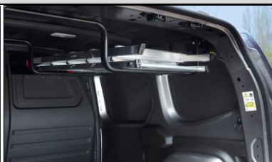
Med Easy Inside Rack får du undan långa föremål från golvet med genomlastningslyckan ovanför passageraren
