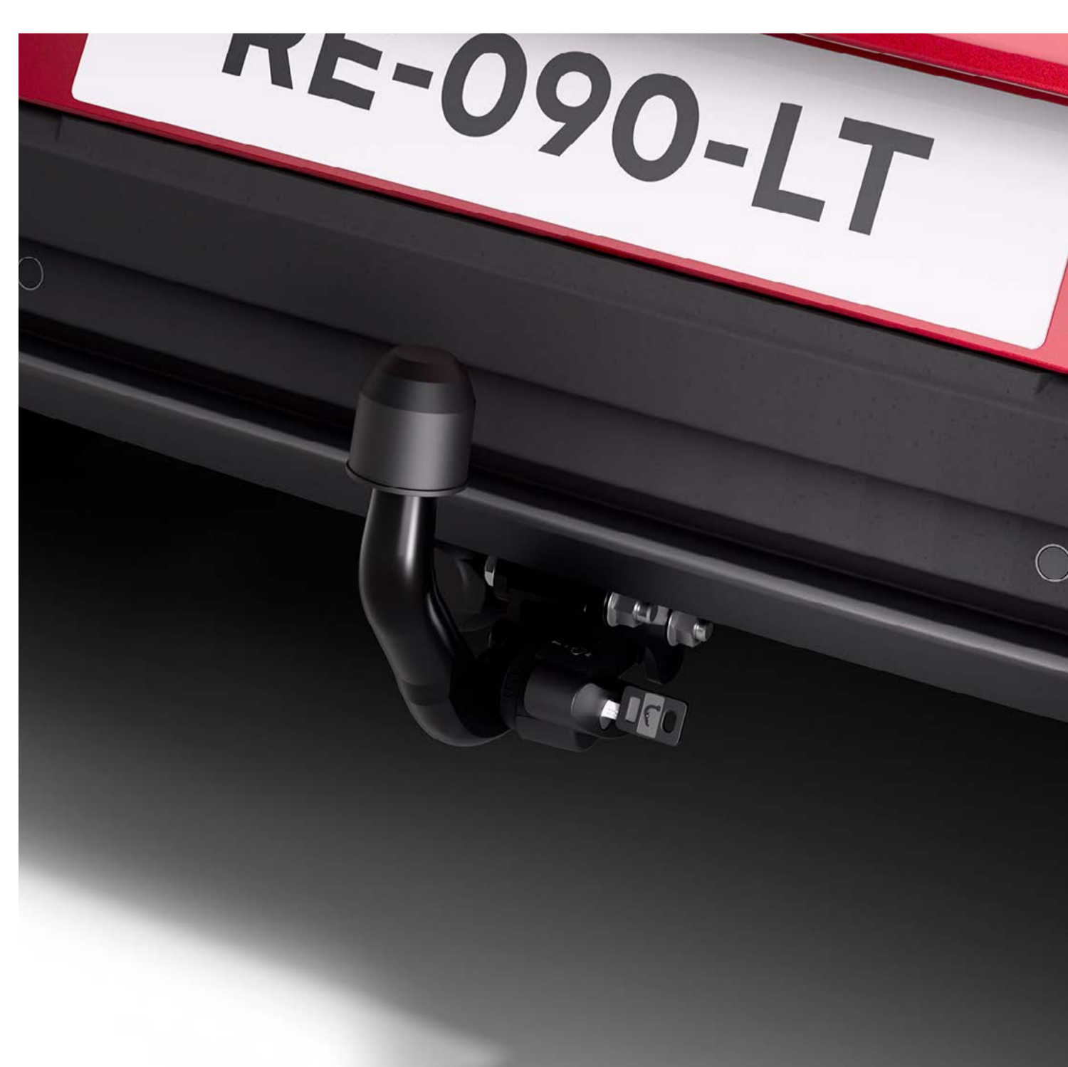
ťažné zariadenie demontovateľné bez náradia
