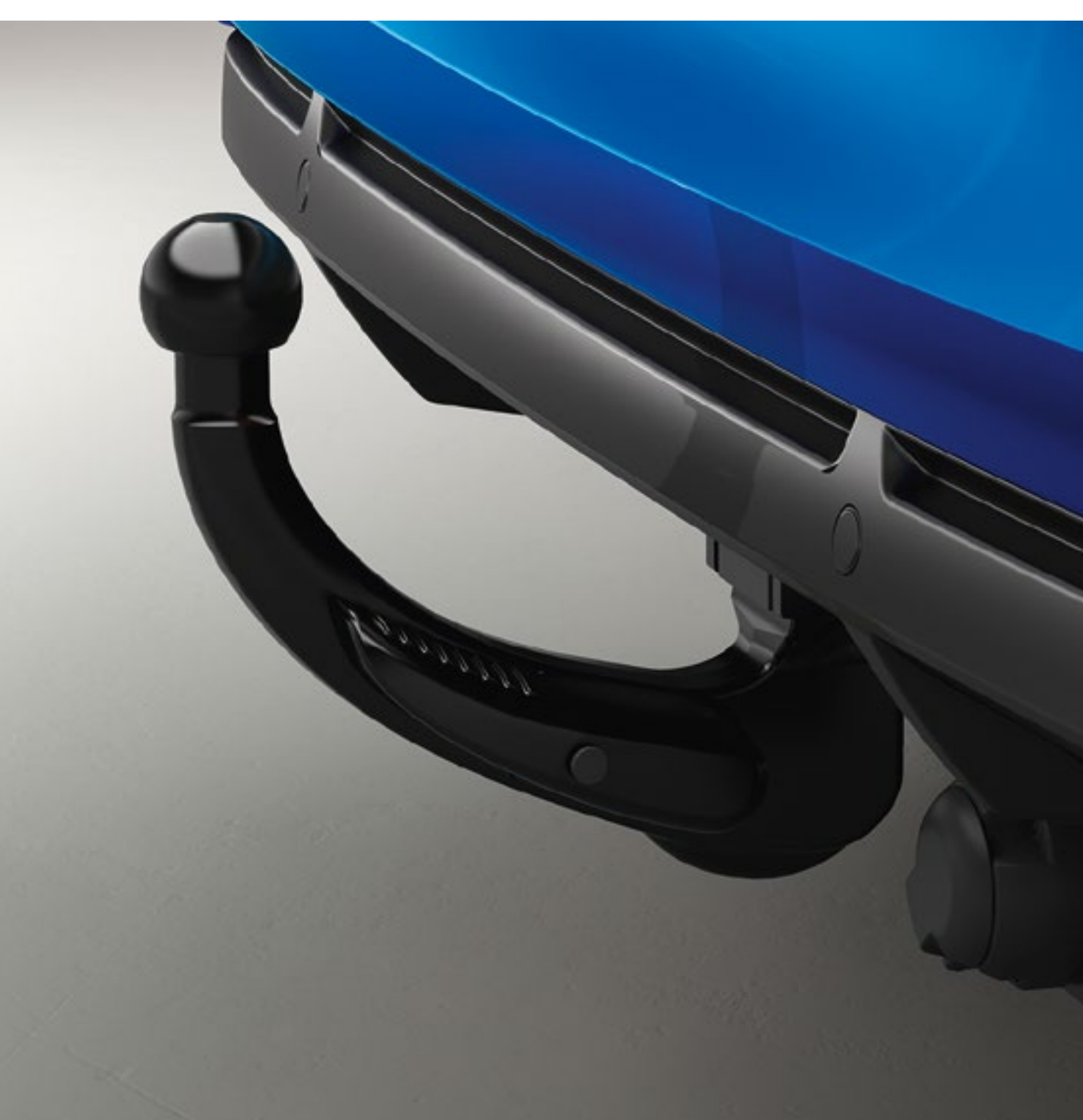
ťažné zariadenie demontovateľné bez náradia
