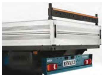
Zadný demontovateľný rám s otvormi pre fixáciu nákladu s max. zaťažiteľnosťou 300 kg.
