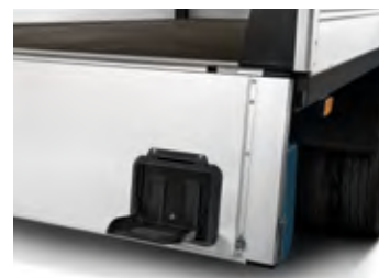
Integrovaný schodík v zadnom paneli.
