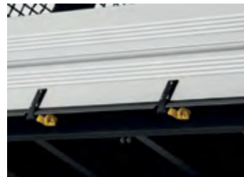
drážka v bočnici a háky pod príviesom pre uchytenie plachty či fixačných pásov
