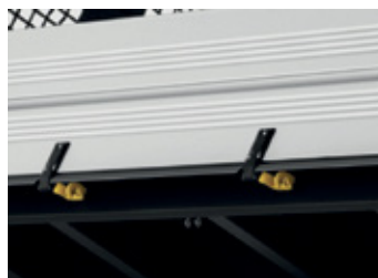
Drážka v bočnici a háky pod prívosom pre uchytenie plachty či fixačných pásov.
