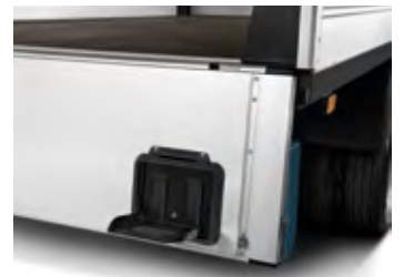
integrováný schodík v zadnom paneli
