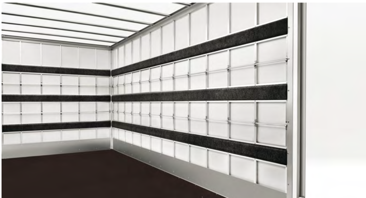
Nákladový priestor s priesvitným stropom a ochrannými bočnými lištami.
