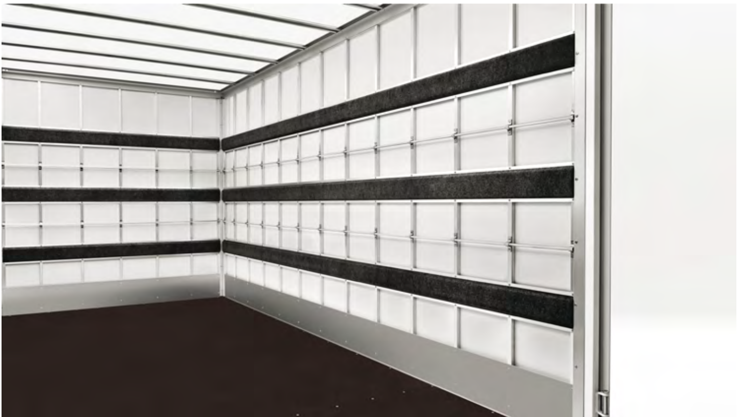
Nákladový priestor s priesvitným stropom a ochrannými bočnými lištami.
