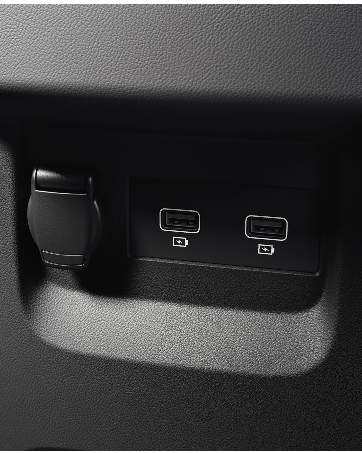
arka koltukta seyahat eden yolcular için iki USB portu ve bir 12 v bağlantı soketi
